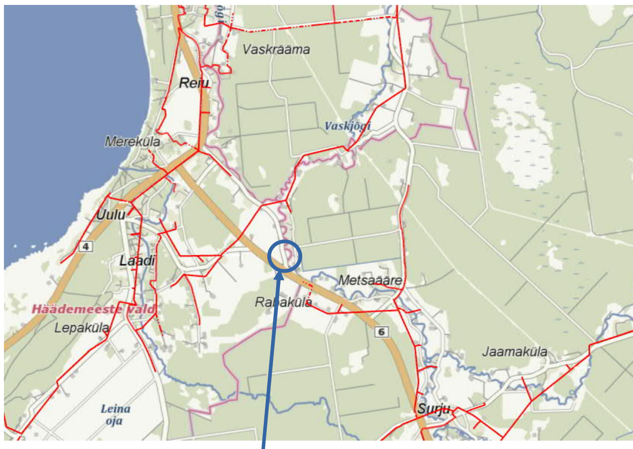
Joonis 1.1. Projekteeritud 0,4 kV maakaabelliin ja jaotus- ning liitumiskapp.
